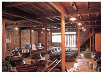
仕込み用の樽は、湿度を安定 させるために土に埋めている
